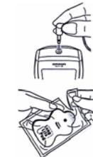
2. Nối dây điện cực với máy chính. Ấn phích cảm dây điện cực vào giác cảm như hình vẽ bên phải.
