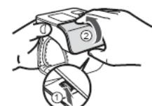
2. Lắp 2 pin alkaline (LR03) 1,5V "AAA" vào khoang chứa pin, sao cho các cực (+) và (-) đúng như đã chỉ ra trong khoang chứa pin và sau đó đóng nắp đậy pin lại.
