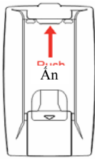
Mở nắp khoang chứa pin
